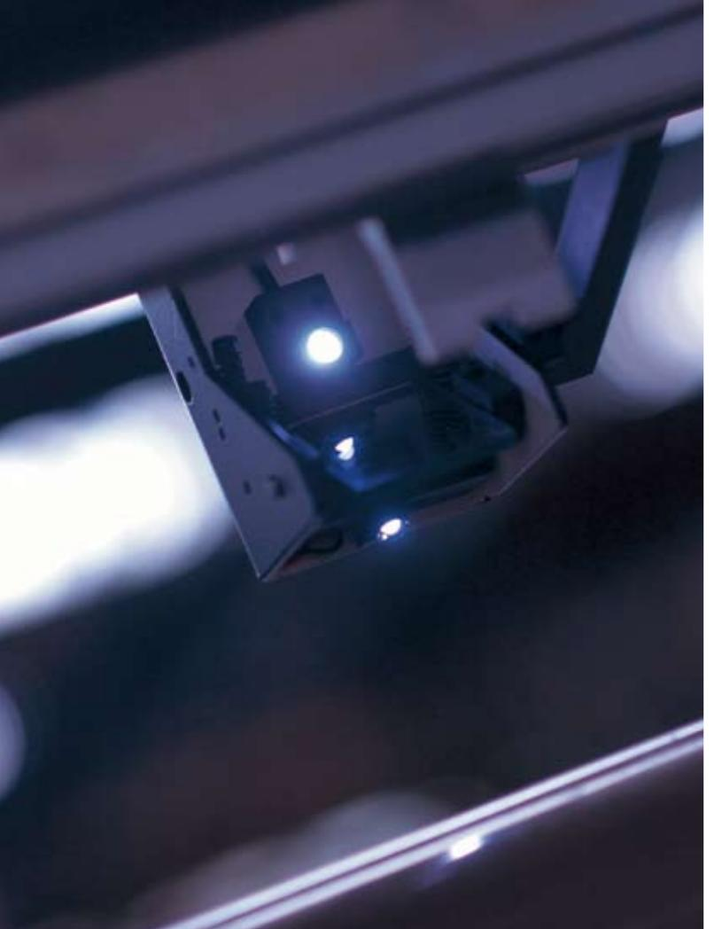
I prodotti della linea **UNICA** e **OMNIA** si avvalgono di un dispositivo brevettato di trasmissione di moto rotatorio per cilindri e/o mandrini delle stampatrici flessografiche senza ingranaggi. L'applicazione laser DPCS (Digital Pre-mount Control System - patent pending), presente nei prodotti **UNICA 343 VM** e **UNICA 340 VM**, controlla e misura le tolleranze di camicie, carrier, mandrini, anilox, biadesivi e cliché per ottimizzare qualità e velocità di stampa.
